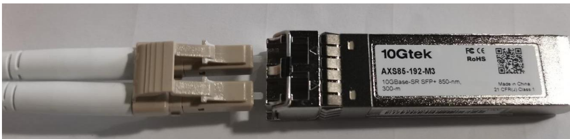
图 3-5 光纤与 SFP+ 光模块连接
