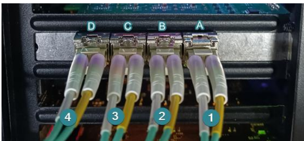
图 3-8 SFP+ 光模块与采集卡连接
