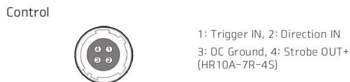
图 2-3 触发针脚定义
